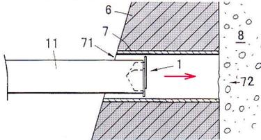
(図7) 装着用差込パイプの先端で水抜パイプの奥の土砂を押し。
