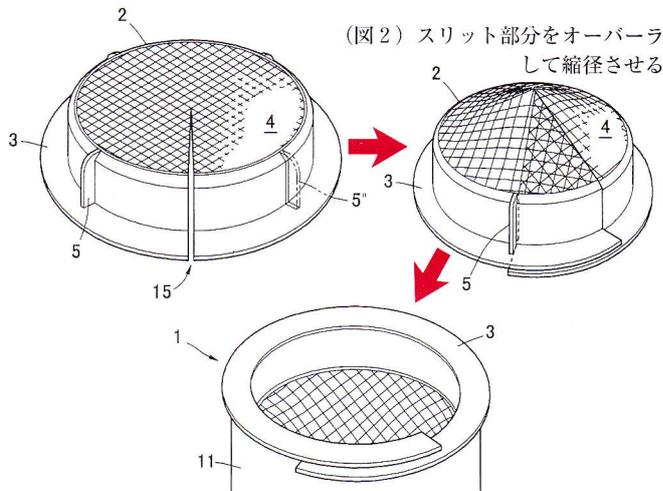
（図3）縮径させた状態で装着用差込パイプの先端に取付ける。
