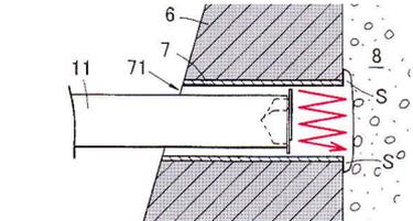
(図8) 棒状体で、縮径して山形になったNKフィルターの山頂を中心に突く。
