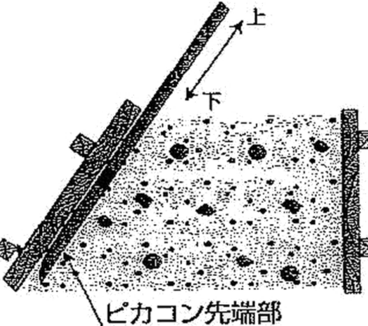
打設完了後、適当な時間経過後（参考15分～）再度ピカコンを型枠表面に沿って、上下に動かしながら差し込み、底面に達したら上下に動かしながらゆっくりと引き上げる。
